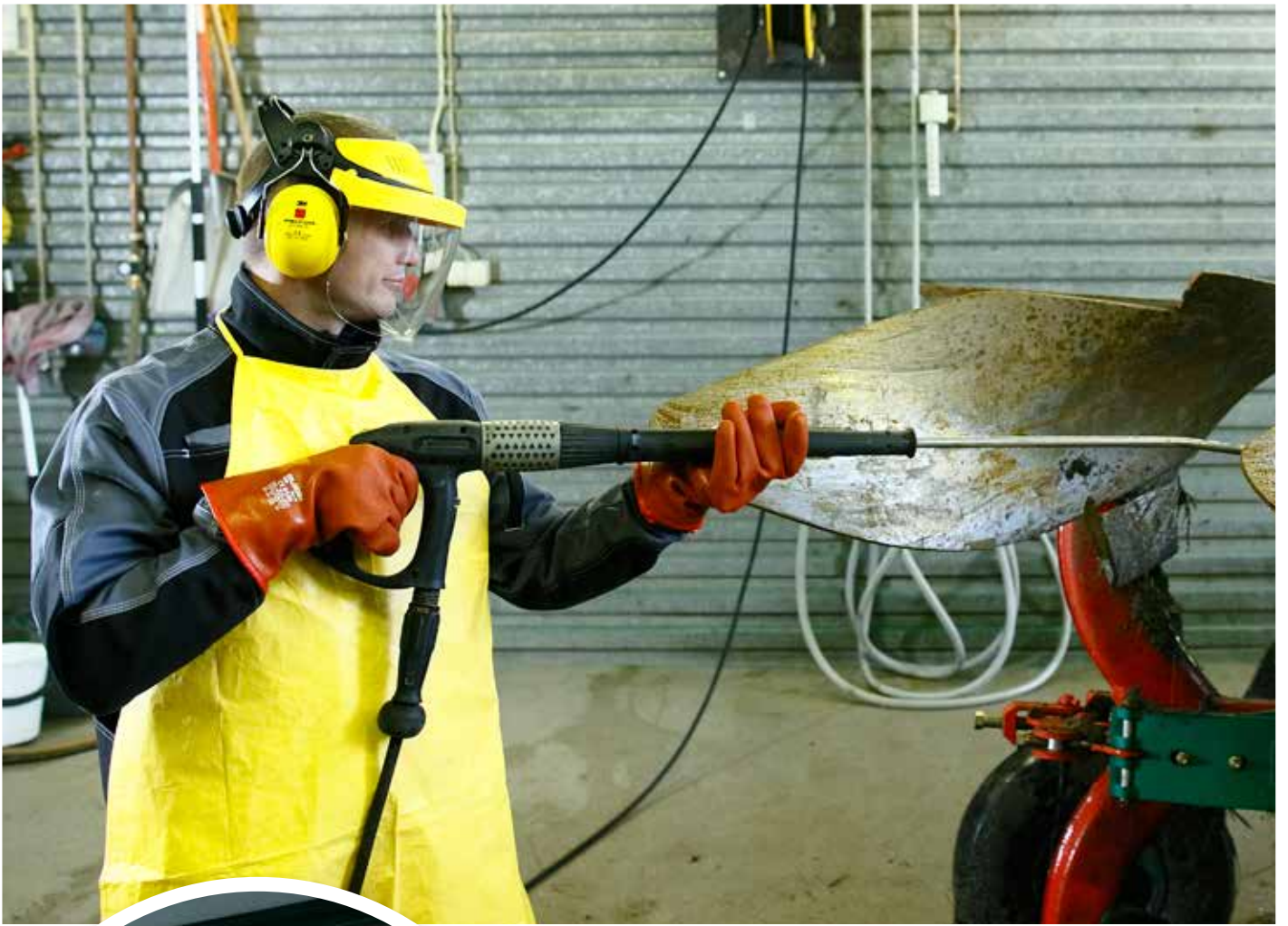
Kuulonsuojain- visiiri -yhdistelmä soveltuu monenlaisiin töihin, joissa ei tarvitse suojautua hengitysilman epäpuhtauksilta.
